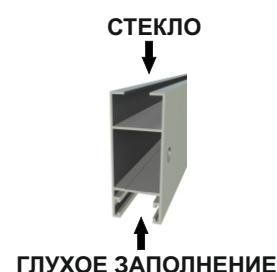
Вставить в двери заполнение в паз профиля и установить верхнюю направляющую **АТП602max**, закрепив ее при помощи винтов **TK203**. По периметру установленного заполнения с двух сторон необходимо установить резиновый уплотнитель **TPU004** (
