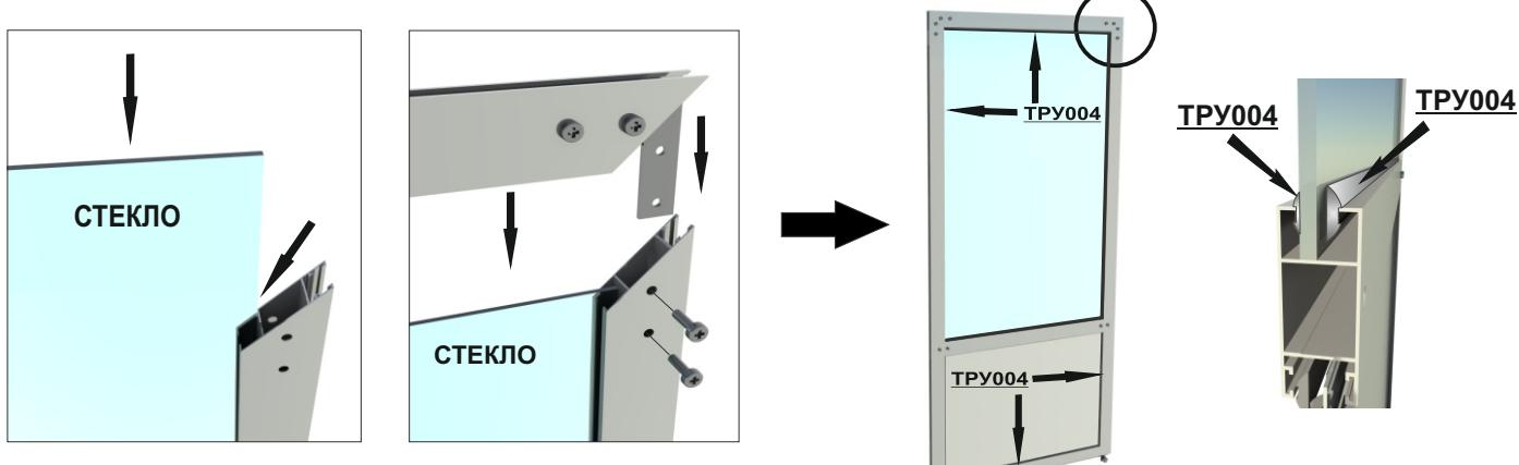
Вставить в двери нижнее заполнение в паз профиля и установить нижнюю направляющую **АТП603max**, закрепив ее при помощи Т-образного крепления **TK104** и винтов **TK203**. По периметру установленного заполнения с двух сторон необходимо установить резиновый уплотнитель **ТРУ004** (↗). На Т-образное крепление **TK104** установить ролик с осью **TK105**, закрепив его гайкой **TK202**.
