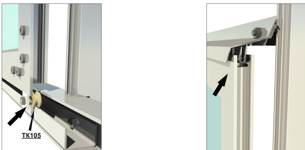
На стойку теплицы **АТП005max** и **АТП006max** установить два щеточных уплотнителя. Поставить на дверь ручки **TK004** (с наружной стороны двери) и планки упоры **TK005** (с внутренней стороны двери) при помощи саморезов **TK209**.
